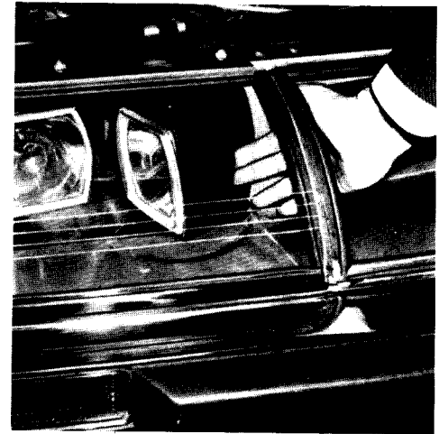
Abb. 33 — Drehen des lenkungsabhängigen Scheinwerfers mit der Hand.
